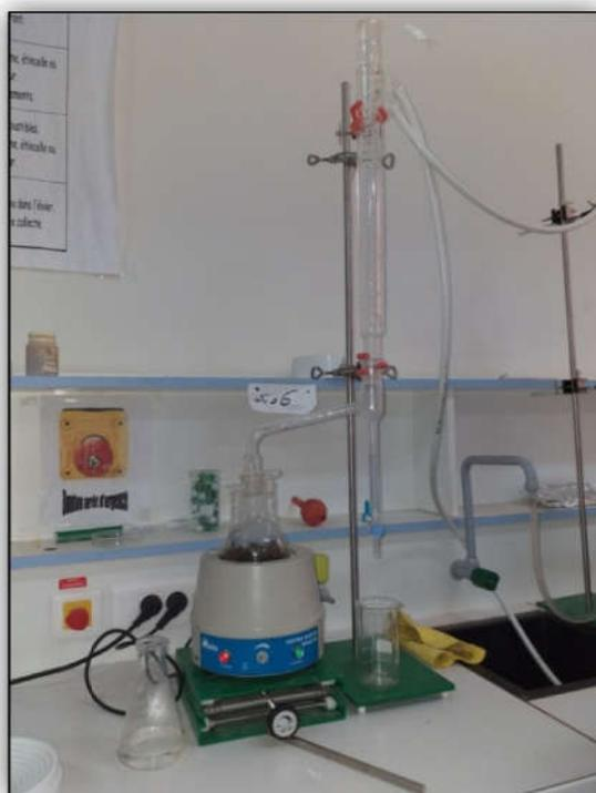
**Figure (08) :** appareil de Dean Stark utilisé pour l'hydrodistillation.
