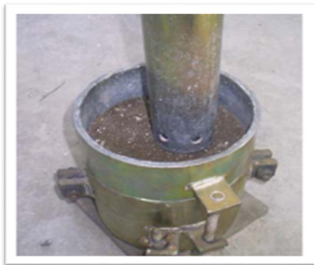
Figure III.14 : compactage d'un BCR selon procédé Proctor modifié
