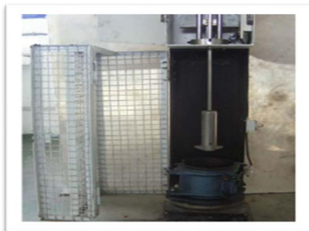
Fig. III.16 : compactage avec table vibrante
