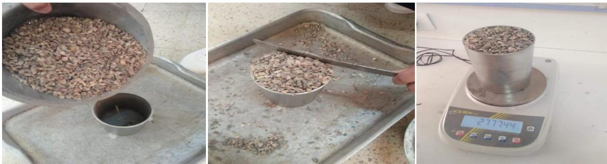
Figure 47: La masse volumique apparente de gravier.
