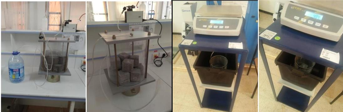
Figure 59: L'appareil pour la pesée hydrostatique.
