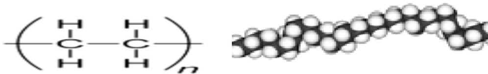
Figure 27: Schéma représentatif du polyéthylène [32]
