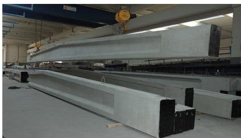
Figure 10:Le béton précontraint. [3]
