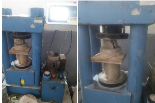
Figure 57:appareil de l'essai de résistance à la compression.
