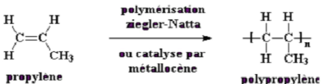
Figure 21:Schéma représentatif de la réaction de polymérisation du polypropylène. [31]
