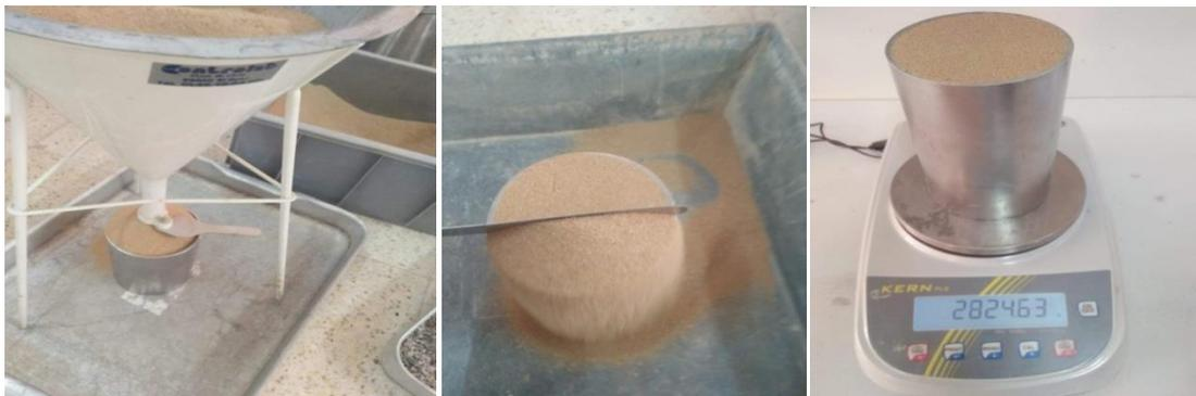
Figure 45: La masse volumique apparente de sable.
