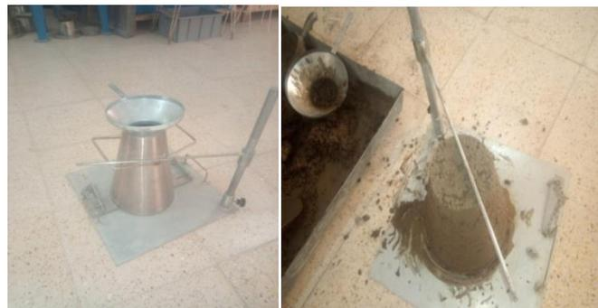
Figure 55: l'essai d'affaissement.
