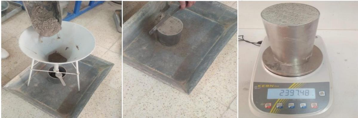
Figure 46: La masse volumique apparente de ciment.
