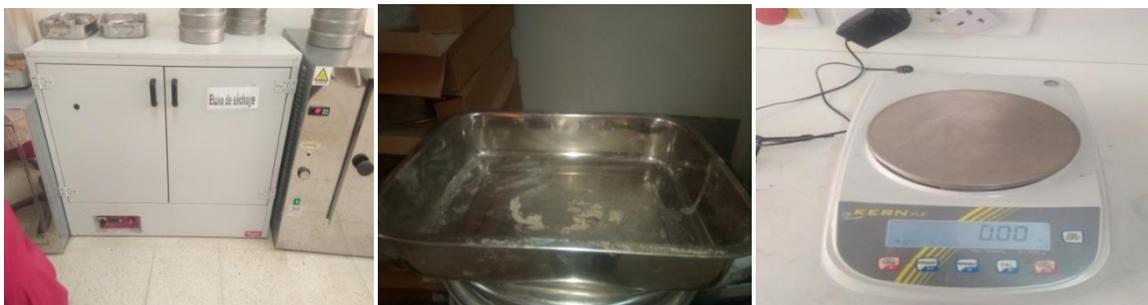
Figure 50: Les matériels utilisés de teneur en eau.
