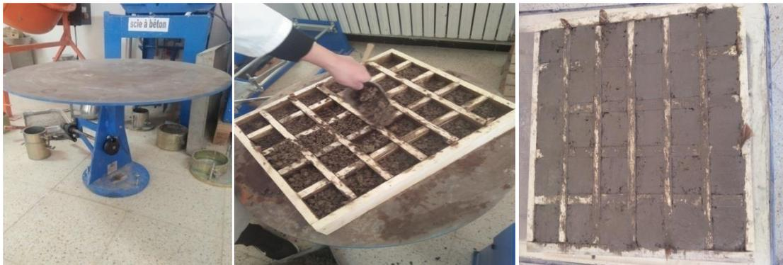
Figure 56:La table vibrant et les moules pour éprouvette de 7x7x7 cm<sup>3</sup>.
