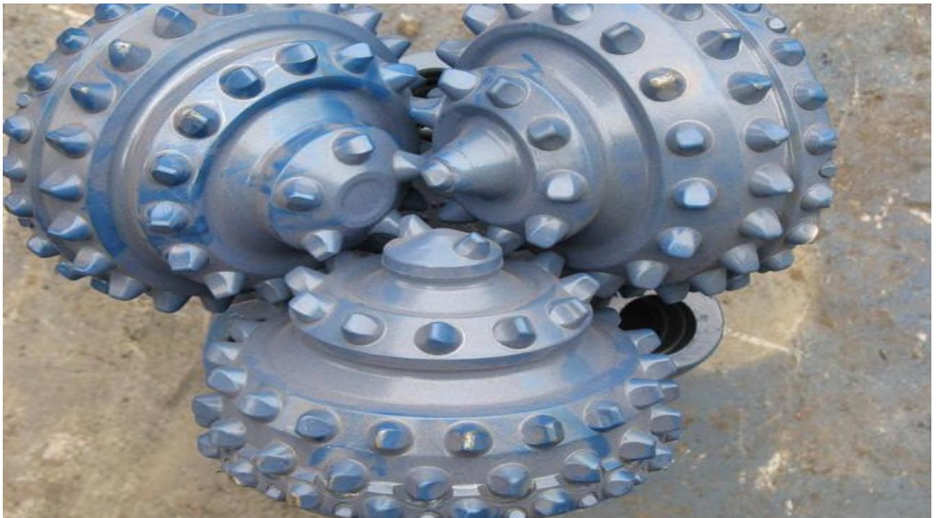
Figure04 : L'outil de forage au rotary : le tricône
