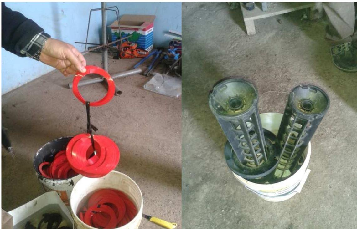
**Figure 14 :** Nettoyage des filtres à disque
