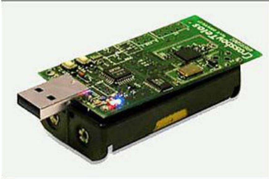
Figure 1.1: Anatomie d'un capteur intelligent Telosb de Crossbow [1]
