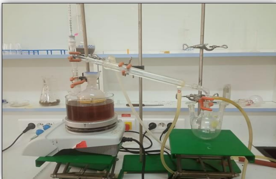
Figure 3 : Montage de distillation sous pression réduite
