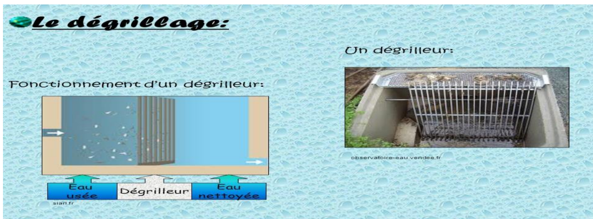
Figure 14: fonctionnement du dégrilleur
