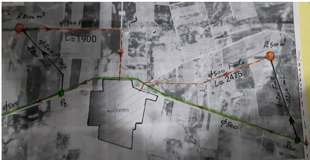
Figure 26: Schéma d'adduction et de distribution du centre d'Ain Beida
