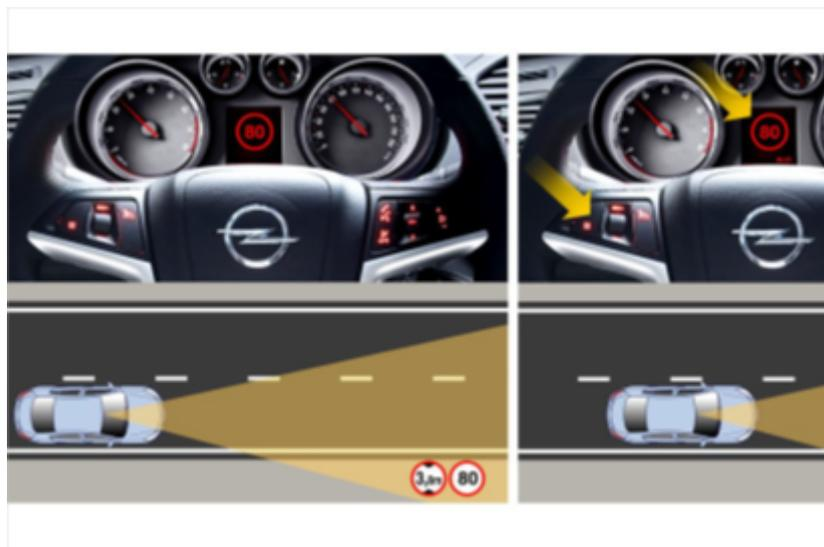
FIGURE 3.1 – Exemple d'application RSR dans une voiture de la marque Opel
