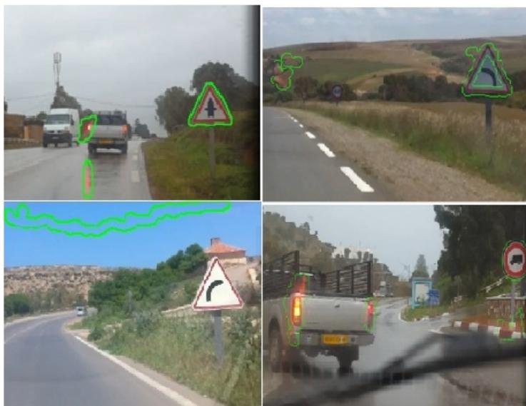
FIGURE 3.23 – Exemple de détection des faux contours bleu et rouge
