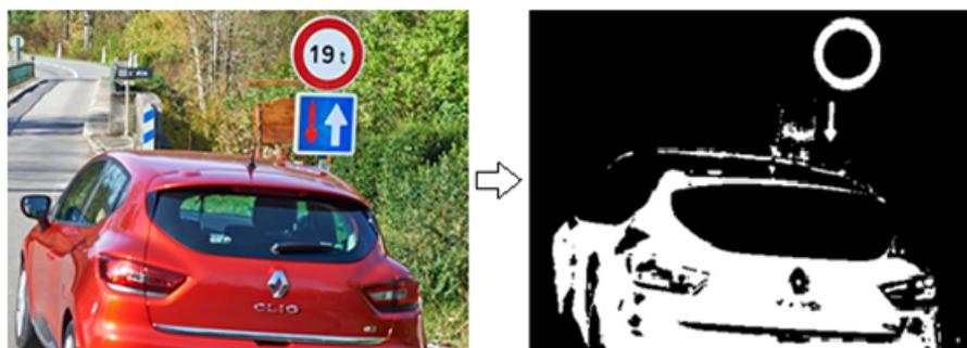
FIGURE 3.18 – Détection des objets rouges qui ne présente pas forcément des panneaux
