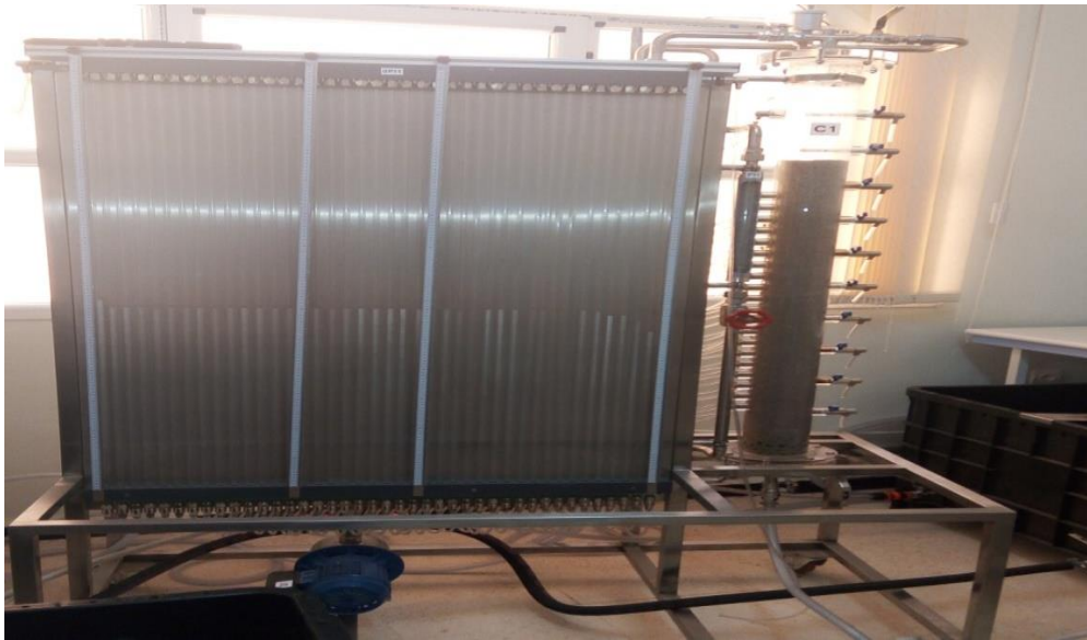
« Photo IV.2 » : filtre à sable à lit profond (laboratoire du génie de l'eau et de l'environnement)
