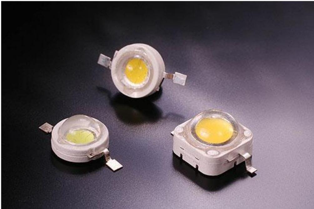
Figure II.11.led de puissance
