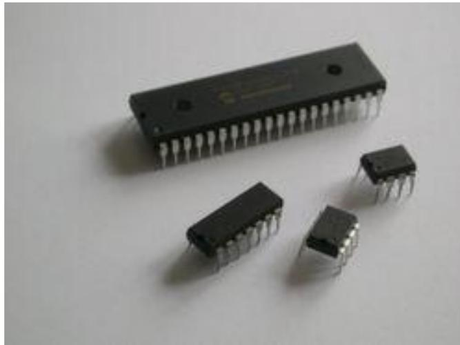
Figure II.1. Les microcontrôleurs
