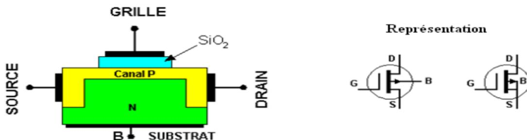
Figure I.8. MOS à appauvrissement canal P
