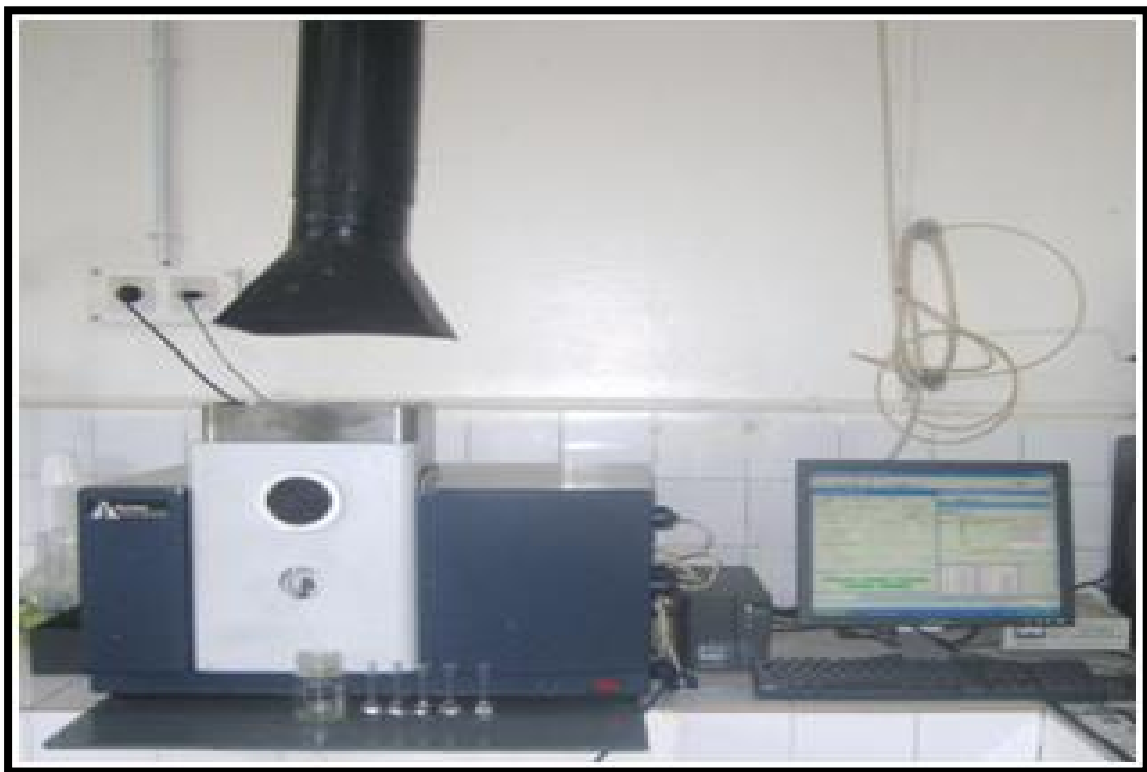
Figure 19 : Spectrophotomètre d'absorption atomique à flamme de type AURORA ai.1200
