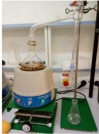
Figure n°7 : Montage utilisé dans l'extraction par hydrodistillation de l'huile essentielle de F. vulgare (photo originale).
