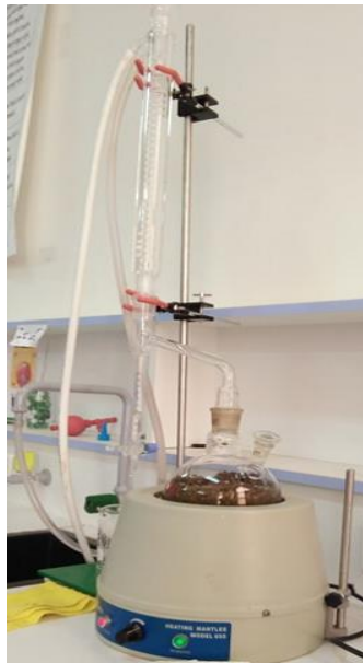
Figure n°6 : Montage utilisé dans l'extraction par hydrodistillation de l'huile essentielle d' O. vulgare L (photo originale).
