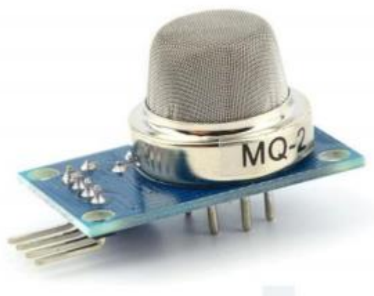
Figure II.4: Capteur de gaz/fumée (MQ-2)
