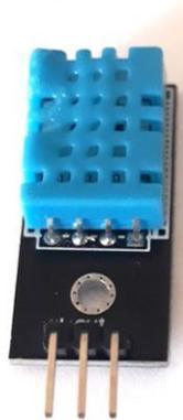
*Figure II.2 : DHT11 (capteur de température et d'humidité)*
