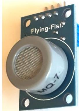
*Figure II.6 : MQ 7 (capteur de CO)*
