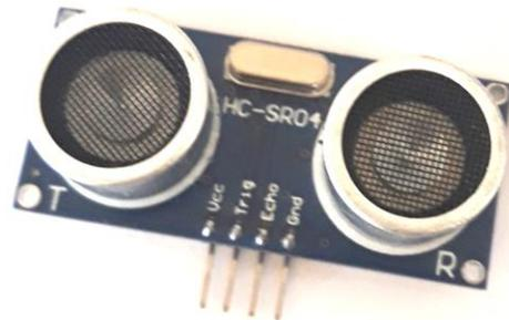
*Figure II.4 : capteur ultrason*
