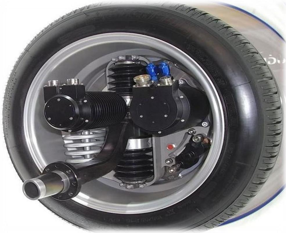
**Figure II-18** : Active moteur roue [24]
