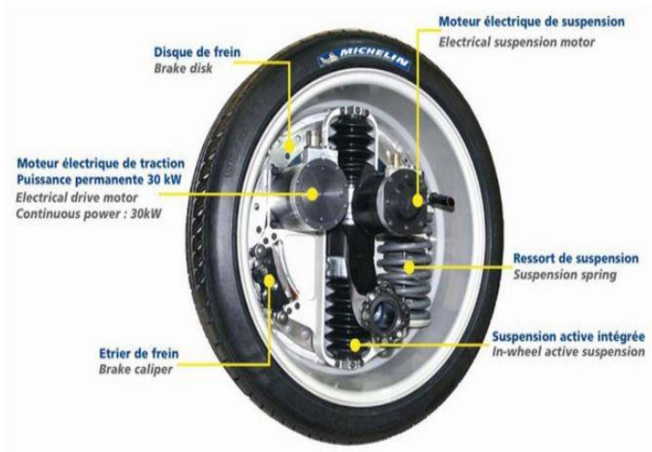
Figure II-21: Active moteur roue détaillé [24]
