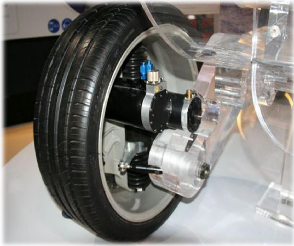
**Figure II-22:** Prototype d'une voiture à moteur roue active [24]
