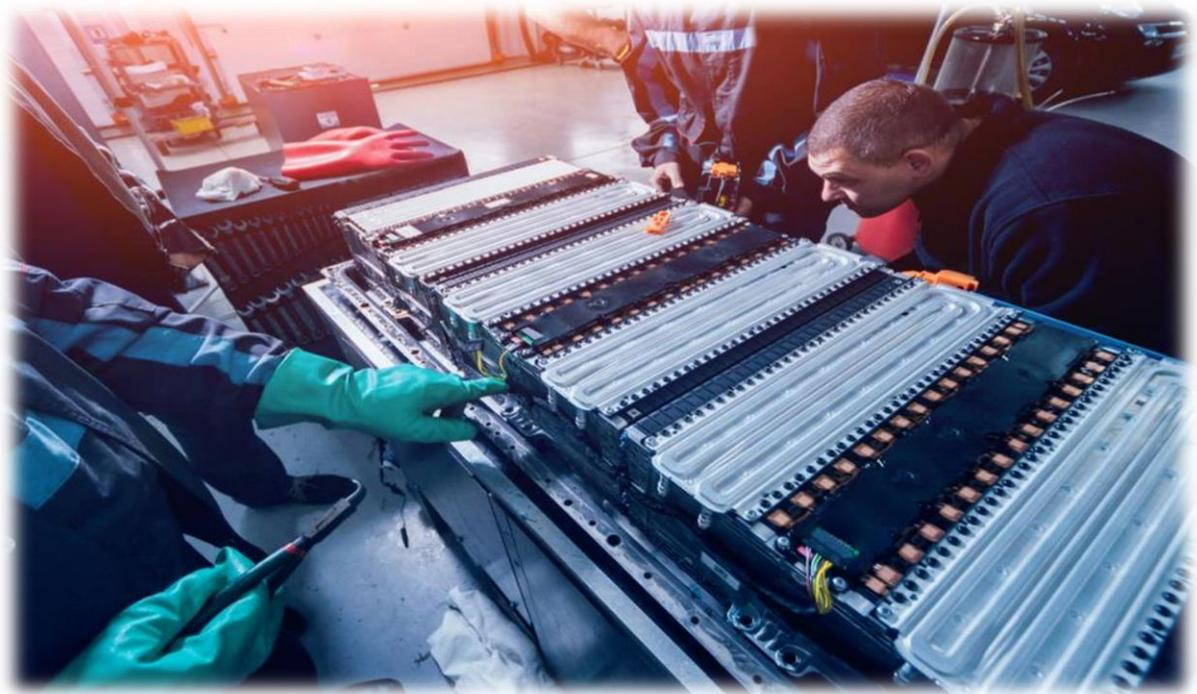
Figure I-9 : Batterie d'une voiture électrique. [14]
