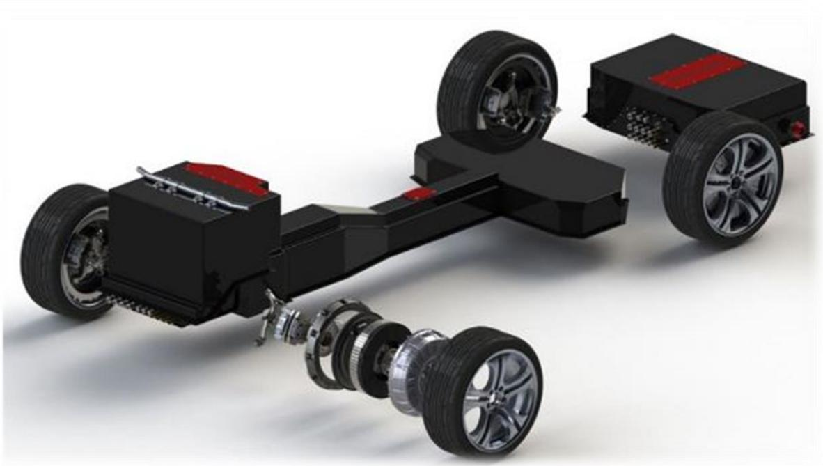
**Figure II-17 :** Châssis d'une voiture à moteur roue IWM [22]
