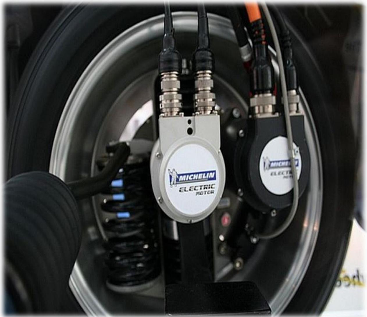
**Figure II-23 :** Active moteur roue en fonction [24]
