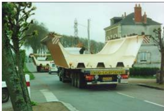
Figure 12: Cadre de raidissage d'un caisson
