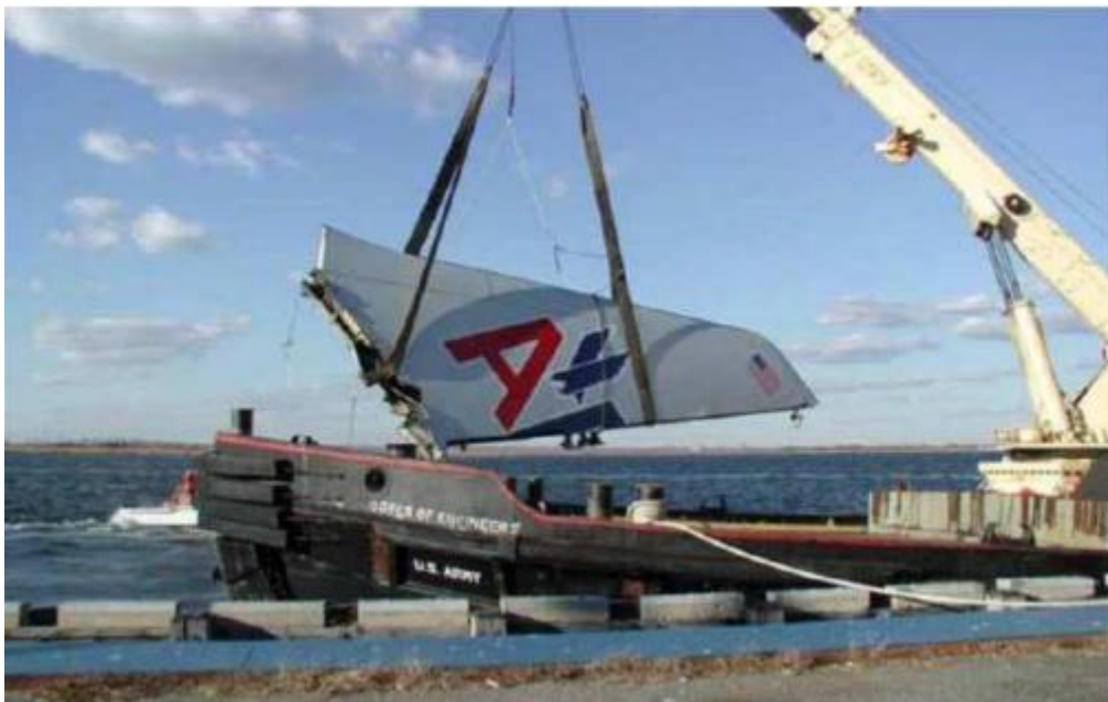
Figure I.2 : Stabilisateur vertical, qui s’est séparée du vol American Airlines 587, conduisant à un accident mortel [7].
