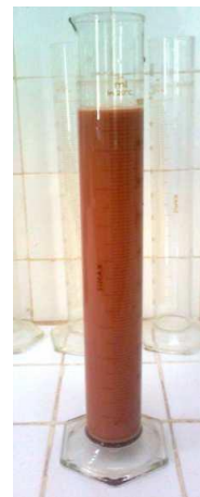
Figure (IV-6): Essai de Sédimentation.
