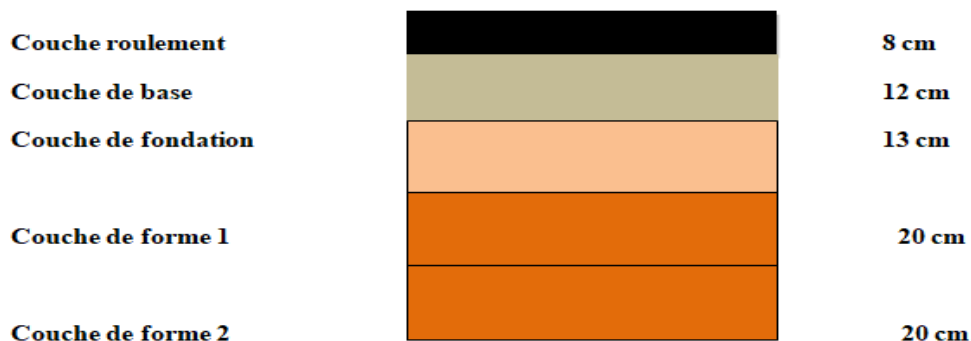
Fig.IV.5: Différentes couches du corps de la chaussée souple
