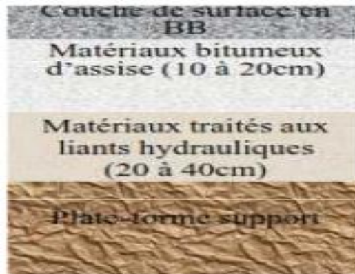
Fig.I.11: Coupe type d'une chaussée mixte [9]
