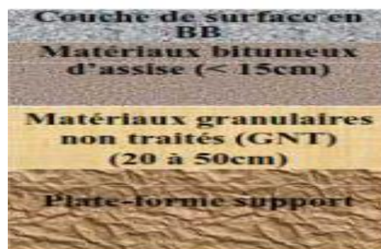
Fig.I.8: Coupe type d'une chaussée souple [9]
