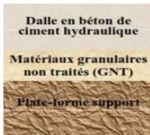
Fig.I.13: Coupe type d'une chaussée rigide [9]
