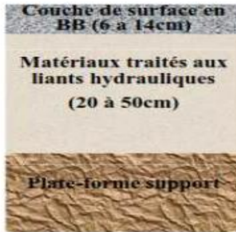
Fig.I.10: Coupe type d'une chaussée semi rigide [9]
