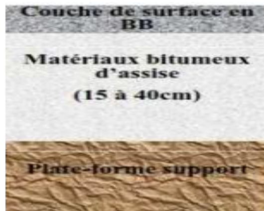
Fig.I.9: Coupe type d'une chaussée bitumineuse épaisse [9]
