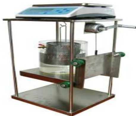
Photo V.8.Appareille de pesée hydrostatique [24].
