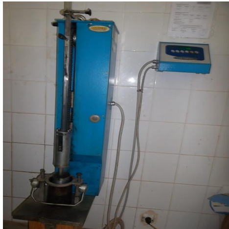
Photo V.11. Dame de compactage
