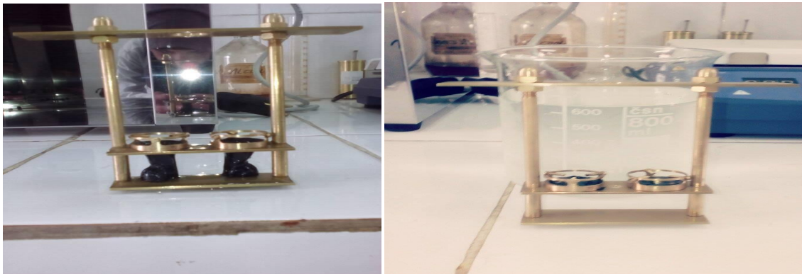
Photo IV.5 : Bille et anneaux en laiton
