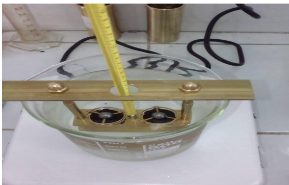
Photo IV.6 : placer les billes au centre du guide
