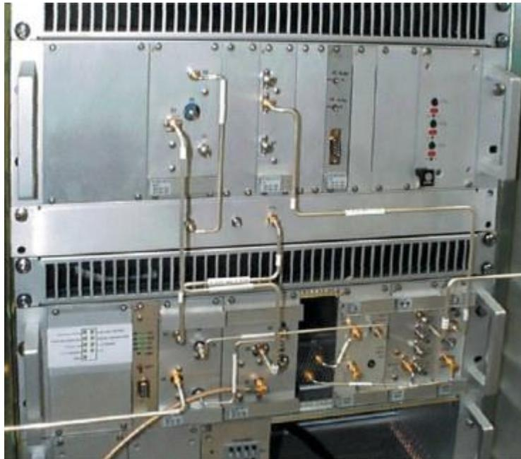
**Figure II.6 :** Récepteur et générateur de signaux d'un radar ASR-E [7]
