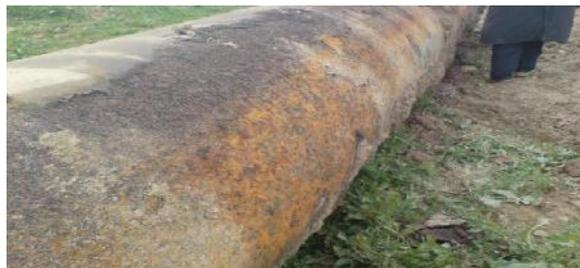
*Figure II-11 : un pipeline infect par la corrosion[28]*
