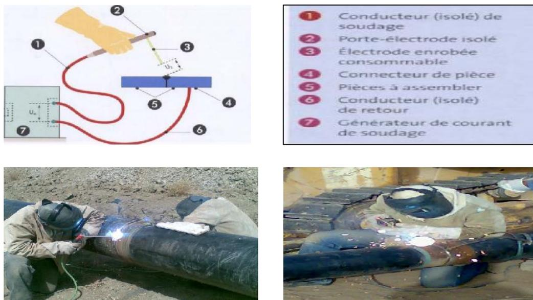
*Figure II-29: circuit de soudage (fiche pratique de sécurité, Le soudage manuel à l'arc avec électrodes enrobées) INRS ED 83 [28]*
