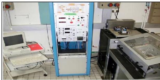
Figure II-47 : Simulateur thermomécanique Gleeble et son rack de contrôle et d'acquisition [24]
