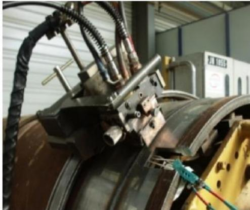
Figure II-42: Mesures de température en conditions réelles de soudage (bitorche, bride interne en cuivre) [25]
