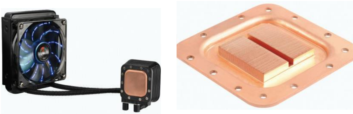
Figure I-11 : Refroidissement liquide à micro-canaux. [16]
