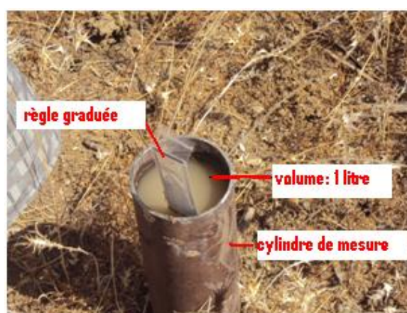
Figure 26. Test d'infiltration au monocylindre (Boughalem., 2007);
