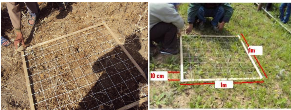
Photo 15. Méthode des points quadrats ; un test simple et facilement applicable sur terrain (Boughalem., 2007)
