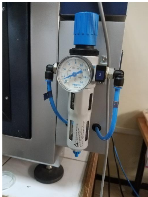
Figure 1.8: Photo de régulateur de pression pour l'appareil de spray pyrolyse.
