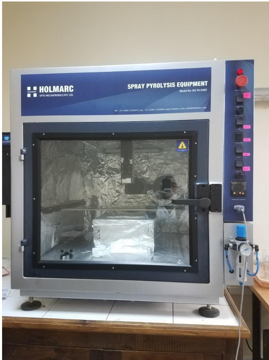
Figure 1.4: Dispositif de Spray pyrolyse ( modèle n° HO-TH-04, Holmarc Ltd, Inde ) du laboratoire de physique de l'université d'Oran1.
