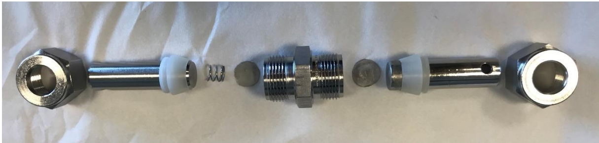
Figure 25: Différents composants de la cellule Swagelok.
